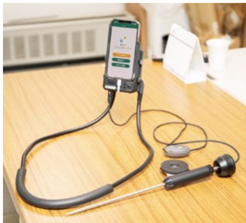
「音とりくん」は熟練の耳がなくても誰もが簡単に使える漏水確率を調べる装置。骨伝導の技術を持つ会社と共同で開発した。さまざまなご縁が新たな開発につながる (j)
