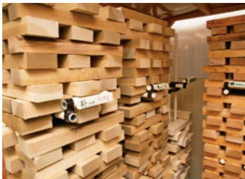
さまざまな性質を持つ7種類の木材を、一度乾燥させた上で適切な含水率に調湿する。「もくろック」製造に欠かせない精密加工前の重要な工程(j)
