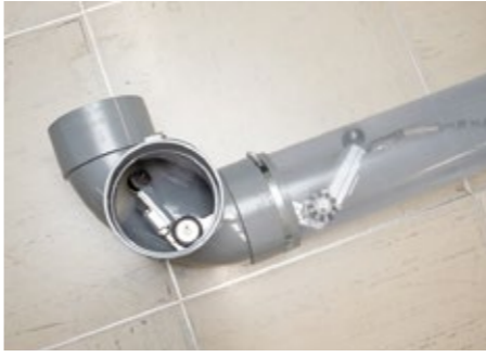
上：蛇型配管検査ロボット「配管くん」。「設備業プラットフォーム」を築ききっかけとなった。現在はいずれも関連会社の(株)弘栄ドリームワークスが担当している／中：配管の中を進む「配管くん」。実際には見えない配管の中を自在に動き、内部を「見える化」する(j)／下：曲がり角でも自在に変形して難なく通過できるのが、蛇型ロボットの最大の特徴(j)
